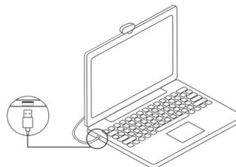
将 USB 接口插入电脑或笔记本设备，系统即会自动安装驱动程序。安装完成后，打开需使用的视频通讯软件，在视频参数设置中，将默认摄像头选项设置为 A1 网络摄像机即可。
